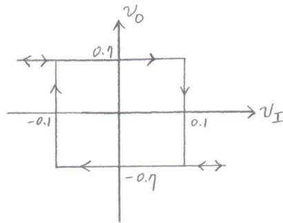
**12.20**  $V_{TH} = \left( \frac{R_1}{R_1 + R_2} \right) (V_o - V_\gamma)$
