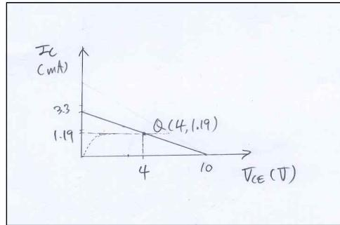
**3.22** 결과로부터 동작점에서 컬렉터 바이어스 전류( $I_{CQ}$ )는  $10\mu\text{A}$ ( $1.19\text{mA} \rightarrow 1.2\text{mA}$ ) 변화하고,  $V_{CEQ}$ 는  $24\text{mV}$ ( $4\text{V} \rightarrow 3.976\text{V}$ ) 변화함을 알 수 있다. 이것은  $\beta_{DC}$  값이 20% 증가하더라도 동작점의 변동은 거의 없음을 알려준다.
