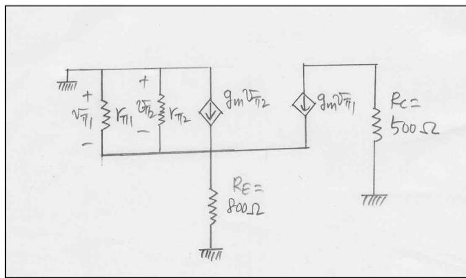
(c) 소신호 파라미터  $g_{m1}, g_{m2}, r_{\pi1}, r_{\pi2}$
