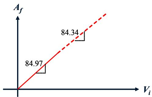
(c) (a), (b)의 결과로부터, 개방회로 이득의 비선형성에 대해 페루프 이득의 선형이 우수한 구조는 그림 (b)이다.
